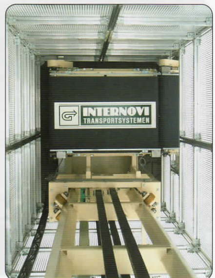
Binnenzijde discontinuu lift
