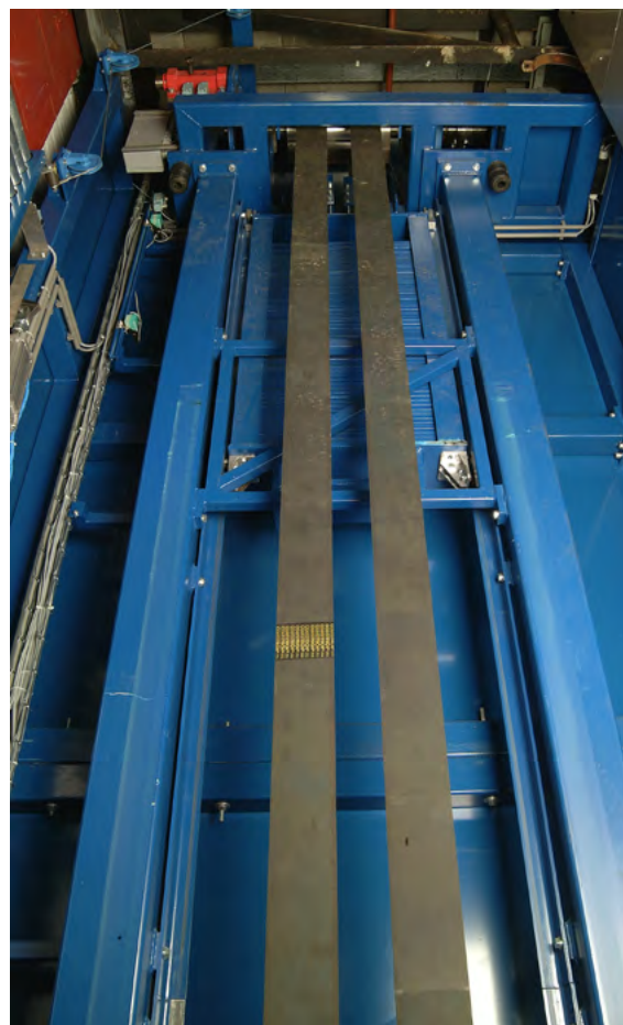
Hefmast met vlakke rubberriem en contra-gewicht
