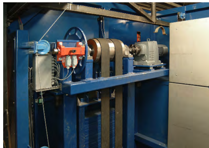
Aandrijfstation met motorreductor, koppeling, aandrijftrommel en vergrendelingseenheid
